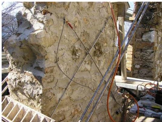
Figura 7: Pannello strumentato per prove diagonali.
