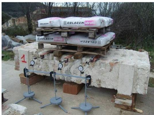
Figura 12: Pannello n.1, disposto in orizzontale, su due appoggi, caricato a flessione.
