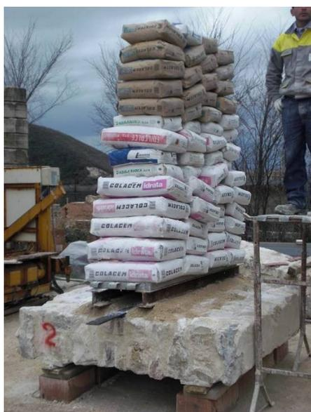
Figura 15: Prova sul pannello n. 2.
