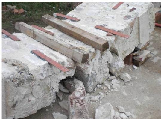
Figura 14: Rottura del pannello n. 1.
