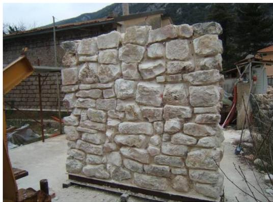
Figura 11: Il secondo pannello sottoposto a prova di flessione.
